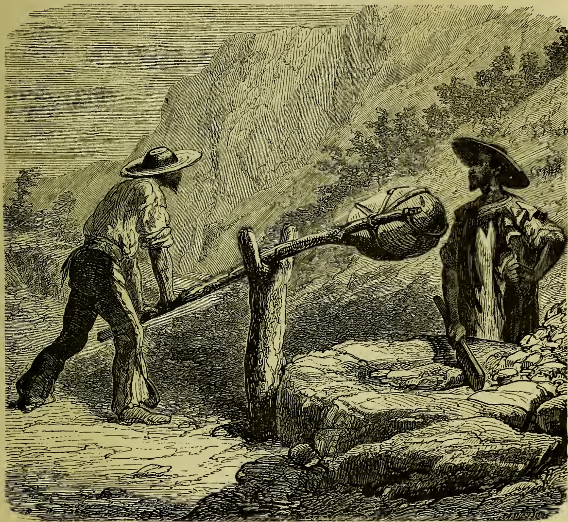
Fig. 148. — Cassage des minerais par le vieux procédé mexicain.
